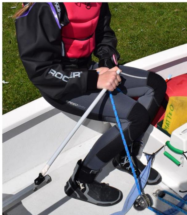
Die Schot wird mit dem Daumen oben und dem kleinen Finger Richtung Block gehalten. So kann man sie bei stärkerem Wind am Oberschenkel „abklemmen“, außerdem hat man so mehr Kraft.
