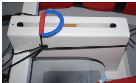
Ein Pinnenausleger (mit Gummigelenk! Nicht Metallgelenk!) ist unbedingt notwendig, die Pinne selbst soll nicht nach oben klappbar sein! Ein Ratschblock für die Großschot erleichtert das Handling sehr.
