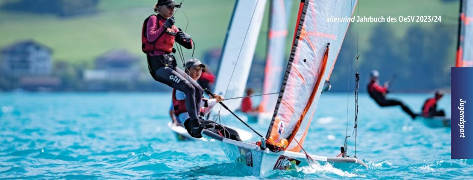
Der 420er ist eine Gleitjolle, die auf allen Kursen einen hohen „Speed“ erreicht und über genügend Sicherheitsreserven verfügt. Die Segel, Fock, Großsegel und Spinnaker sind sehr gut aufeinander abgestimmt und können, wie das Rigg, vielfältig getrimmt werden.
